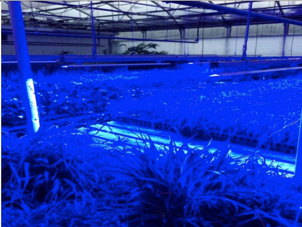
Photo 2. Aperçu de l'installation de l'essai, éclairage DEL à 100 \mu\text{moles}/\text{m}^2/\text{seconde} de 460 nm.
