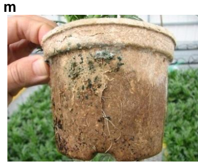
m Moississures et fissures avec racines au travers
